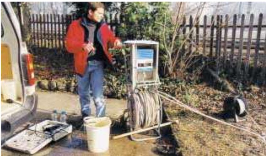
Hydrogeologe beim Messen des Grundwasserspiegels
